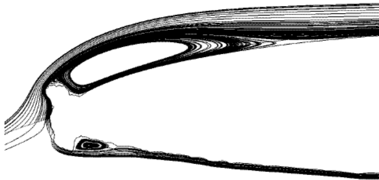
Fig. 2.6: formação de vórtices em decorrência dos “chifres de gelo” [6]
