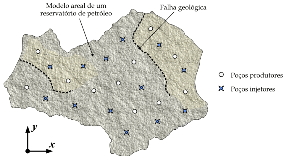
Figura 1.2 Simulação de processos de recuperação secundária de petróleo.
