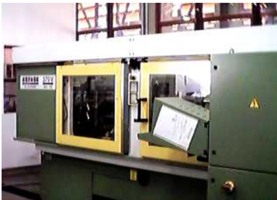
Figura 32 – Máquina Injetora Arburg 370 V (NRPP/UFSAR, 2000).
